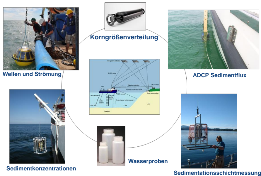
Abb. 8: Illustration der Instrumente, die zur Messung der Sedimentfreisetzung während der Aushub- und Landgewinnungsarbeiten eingesetzt werden
